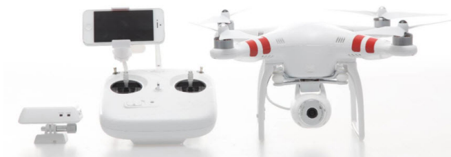
Figur 6 DJI Phantom Vision med integreret kamera og mulighed næsten real-time visning på smartphone.
